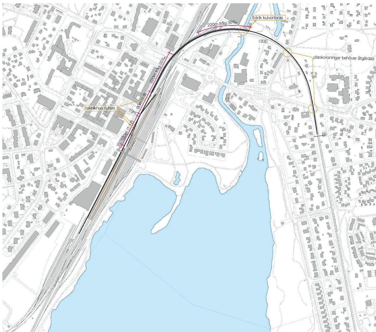
Figur 4 Planskild utfart och påbörjat dubbelspår riktning Växjö
